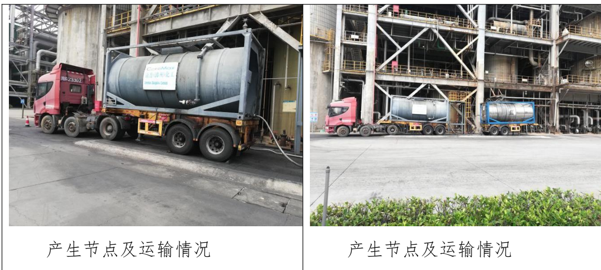
图 4.1.5-6 氧化反应废催化剂产生节点及处置情况
